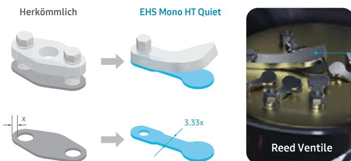
Dank der verbesserten Haltbarkeit und Reaktionsgeschwindigkeit halten die Reed-Ventile einem wesentlich höheren Auslassdruck stand.
