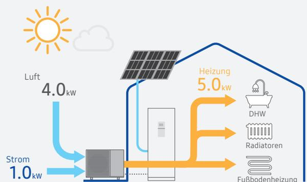
Um 5.0 kW thermische Energie zu erzeugen, benötigt die Wärmepumpe nur etwa 1 kW elektrische Energie und holt sich die restliche Energie aus der Luft\*\*.
