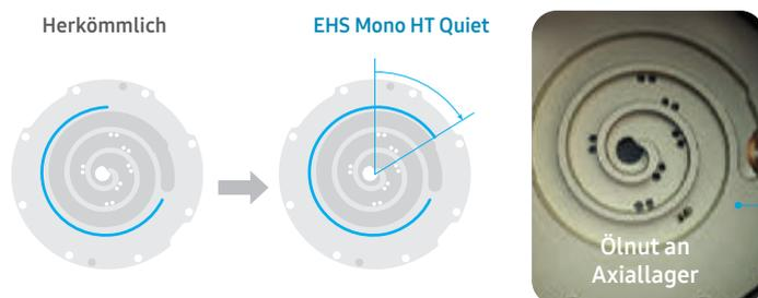
Durch eine verlängerte Ölnut im Lager hat sich die Schmierfläche um etwa 24%\*\* vergrößert. So arbeitet der Kompressor auch bei erhöhtem Druck zuverlässig und stabil.
